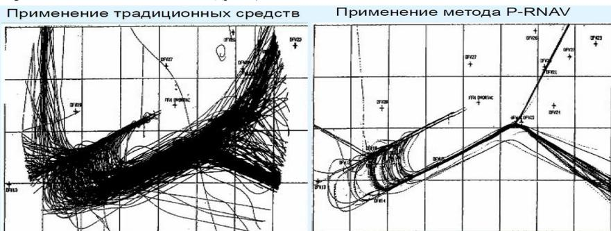
**Рис. 1: Разброс траектории при заходе на посадку**
